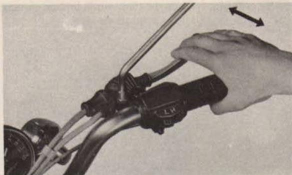
Fig. 4-30 Réglage automatique du frein avant
