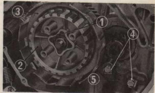
Fig. 3-39 (1) Jonc d'arrêt (4) Rondelle de sureté
