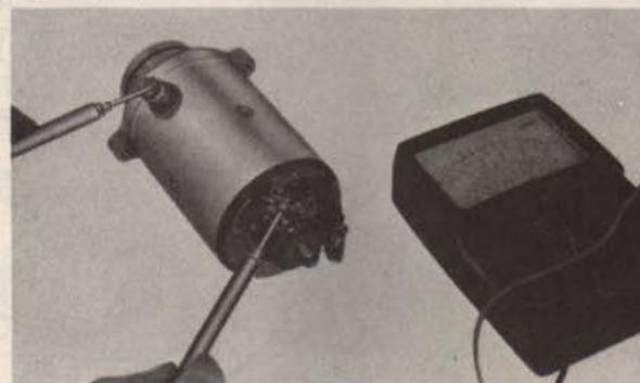
Fig. 3-106 Contrôle de l'état de bobine fixe
