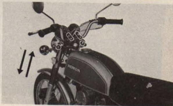
Fig. 2-32 Contrôler de l'état de la suspension avant
