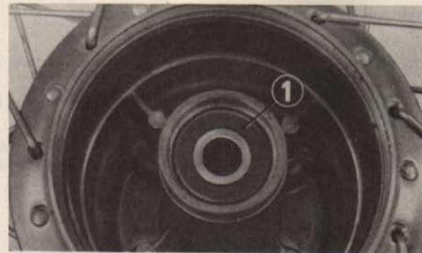
Fig. 4-59 (1) Côté fermé de roulement à billes
