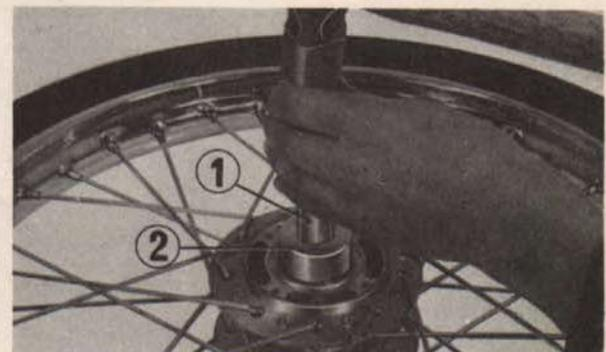
Fig. 4-7 (1) Outil de montage de roulement à billes
