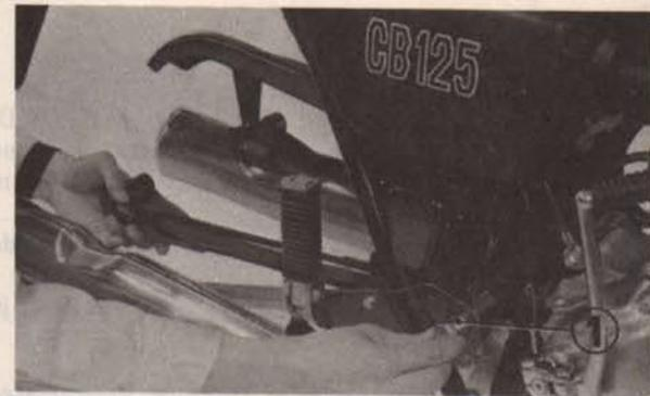
Fig. 4-70 (1) Boulon de l'axe de pivotement de fourche
